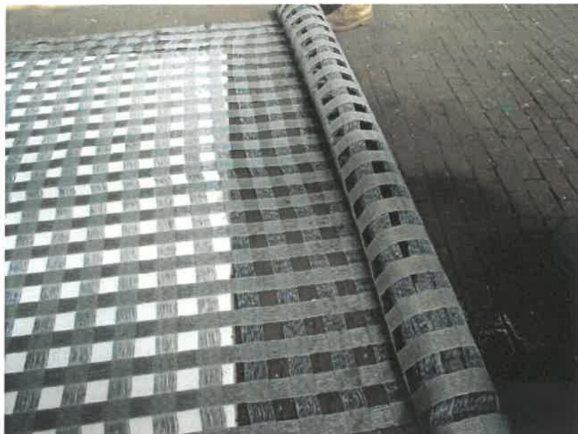
Rys. 3.1.2. Zwijanie do rolki siatki POLLUX2
