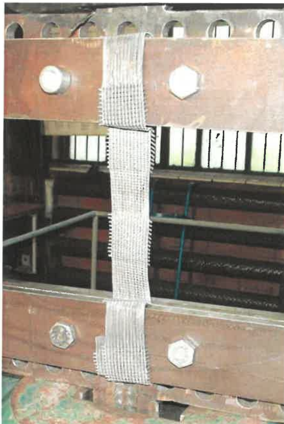
Rys. 2.6.1. Schemat badania pojedynczych pasków (POLLUX2 , paski podłużne)
