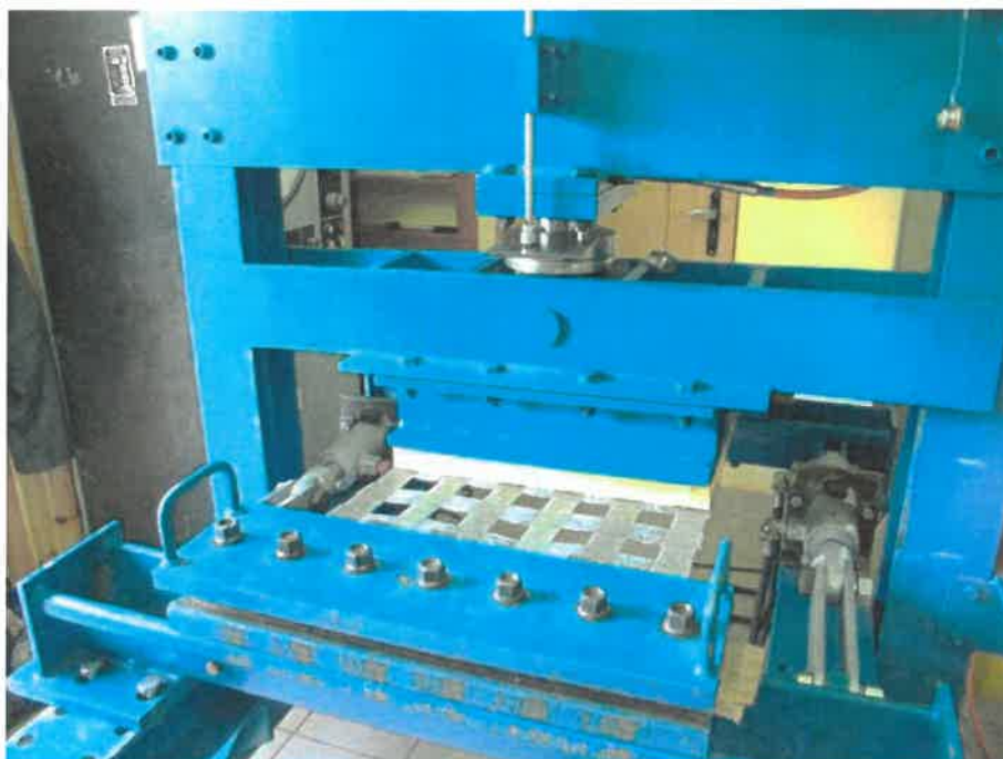
Rys. 2.6.2. Schemat badania siatek na ugięcie (POLLUX2 , paski podłużne)
