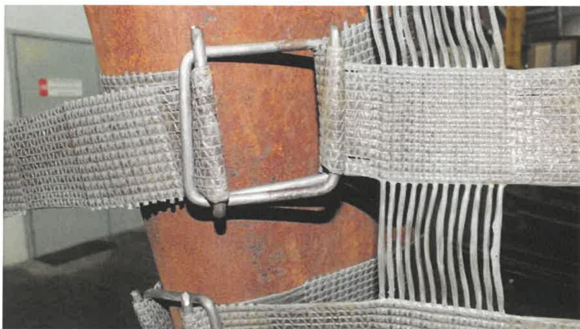
Rys. 4.1.4. Samozaciskowa klamra stalowa z mocowanym paskiem podłużnym siatki POLLUX2 do kształtownika odrzwi obudowy
